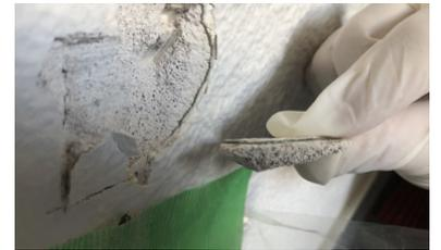
検体は層別に検査を行うため、できる限り粉状にならないように塊（かたまり）で採取して下さい。下地調整剤にアスベストが入っている事が多いためしっかり採取して下さい。
