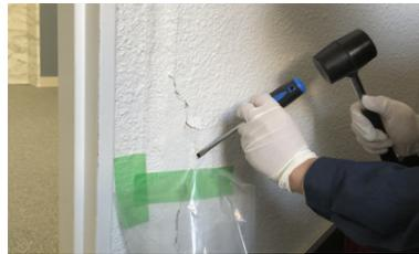
アタッカーを表面から内部に入れ少しずつ検体を剥離採取する。その際、ハンマーを使用し必ず下地調整材まで貫通するよう深く採取する。
